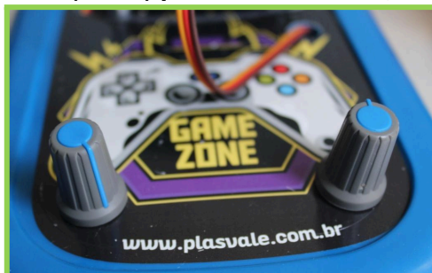
Figura 7 - Botões (Knob) para a movimentação dos servos
